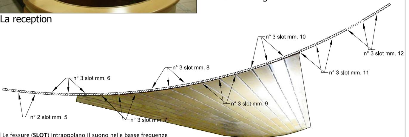
Le fessure (SLOT) intrappolano il suono nelle basse frequenze riducendo i tempi di riverberazione; la larghezza delle slot determina la gamma di frequenze assorbite.
